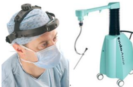
Figura 2.1 Robot Endoassist- Control de la cámara por casco con infrarrojos [5].
