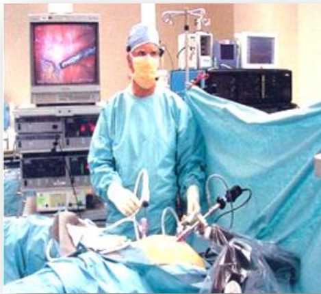
Figura 2.2. Robot Aesop- Control de la cámara por comandos de voz [23].
