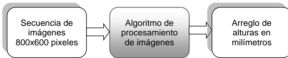
Figura 13. Diagrama en caja negra del algoritmo de procesamiento de imágenes.
