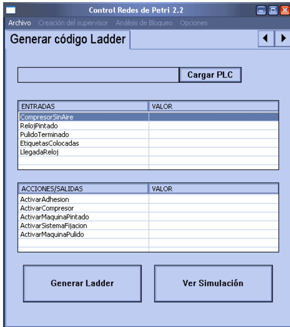
Figura 55. Interfaz para la generación de código ladder con todas las entradas y salidas asignadas.
