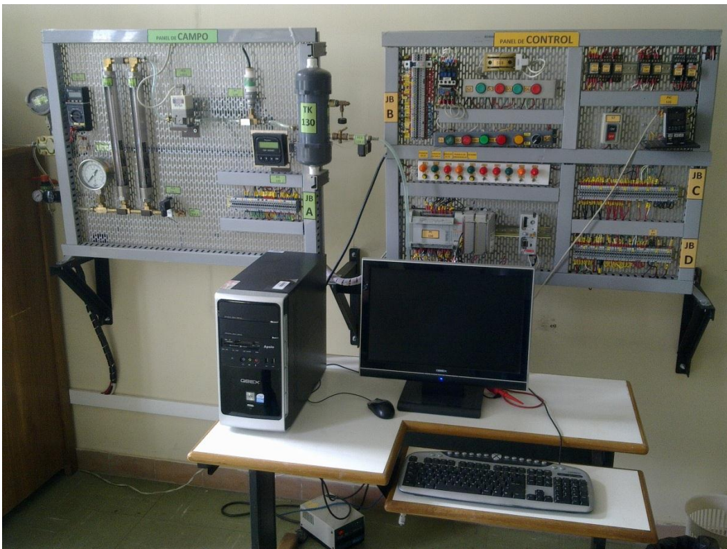
Imagen 3.1. Planta de control de presión
