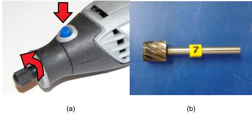
Figura 23. (a) Insertar fresa en el motor (b) Pieza cilíndrica número 7
