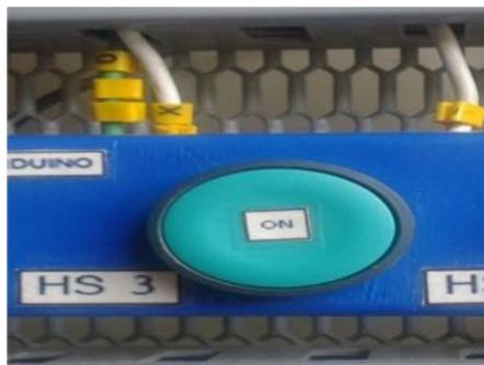
**Figura 4.10** Pulsador para encender el ventilador.
