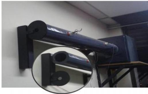
**Figura 4.32** Disturbio instalado en la planta de temperatura del LCP.
