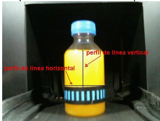
Figura 3.21. Perfiles de línea para encontrar el nivel del líquido de las botellas.
