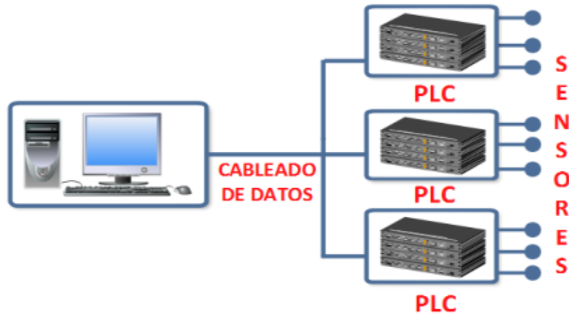
Figura 2.2 Configuración Típica de un SCADA
