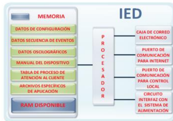
Figura 2.4 Estructura del IED
