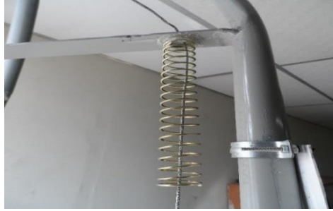
Figura E.4 Guaya insertada a través de los resortes y platina de límite superior.
