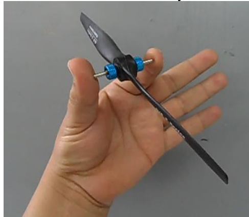
Figura B.3 Posición del balanceador entre las yemas del dedo pulgar e índice
