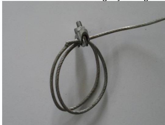
Figura E.1 Circunferencia en un extremo de la guaya asegurada con un perro
