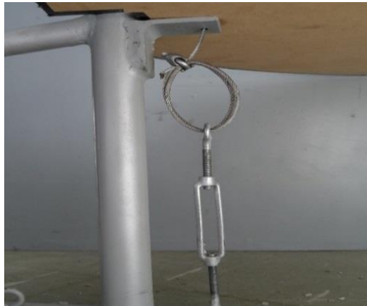
Figura E.3 Guaya enganchada en el tensor e insertada en los orificios de la plataforma
