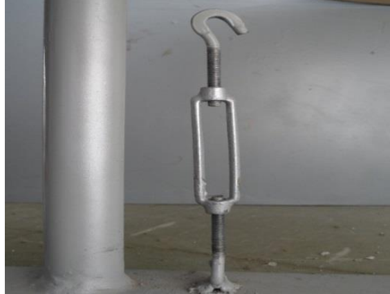
Figura E.2 Posición inicial del tensor
