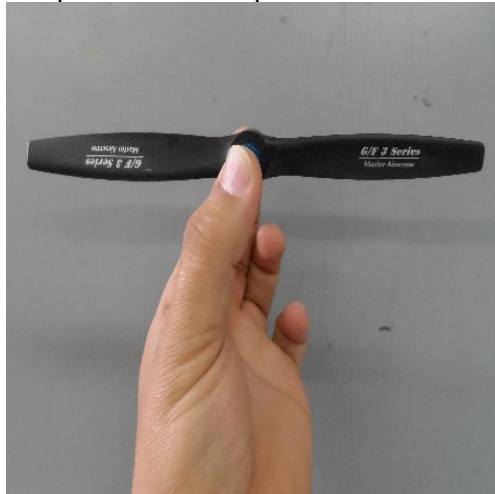
Figura B.5 Posición que nos indica que la hélice esta balanceada
