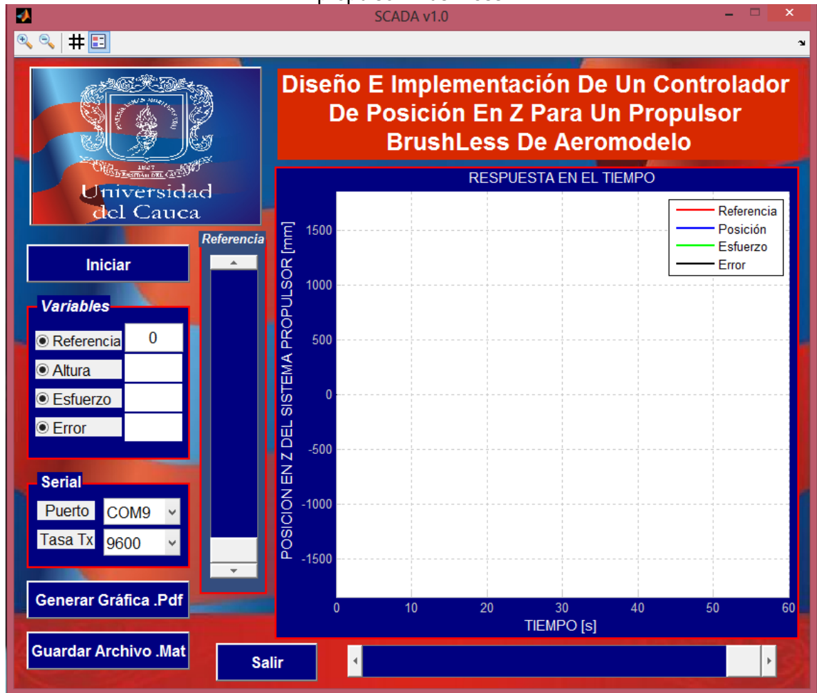
Figura 4.2 Interfaz Gráfica de Usuario para el sistema de control de posición en Z del propulsor BrushLess.
