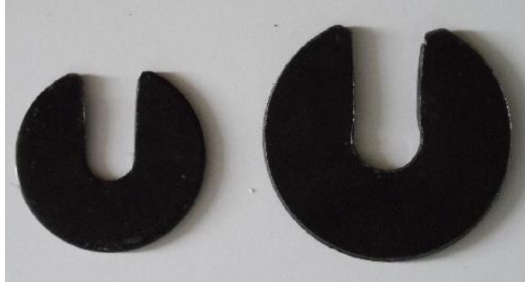
Figura 2.5 Pesas en hierro o carga adicional para el sistema de propulsión BrushLess.
