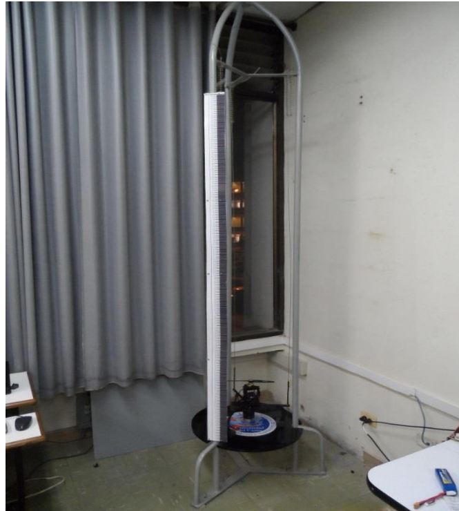
Figura 2.3 Sistema mecánico para el posicionamiento en Z del propulsor BrushLess de aeromodelo construido
