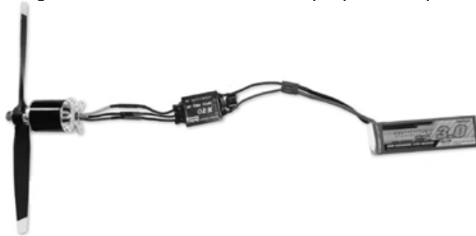
Figura 1.1 Sistema eléctrico de propulsión típico.
