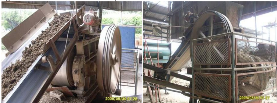
Figura 1.8. Laminador refinador en planta 1.
