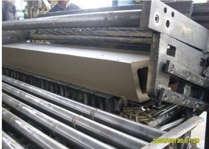
Figura 1.11. Cortador múltiple en planta 1.
