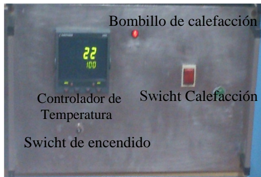
Figura B.32. Panel frontal del sistema de control de temperatura; controlador de temperatura, Swichts de encendido y calefacción y bombillo indicador de calefacción. Fuente propia
