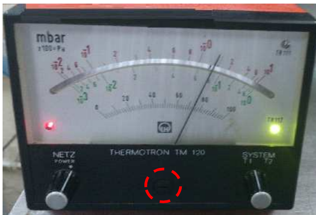
Figura B.26. Resaltado en rojo potenciómetro de calibración del indicador analógico de presión Thermotron TM 120
