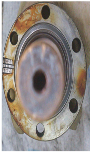
Figura B.2. Cañón- magnetron vista aérea
