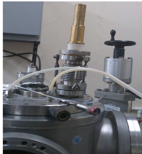
Figura B.25. Acople cámara de vacío cañón- magnetrón
