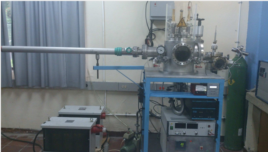
Figura B.43. Vista Equipo Sputtering actualmente (enero 2014) Fuente propia
