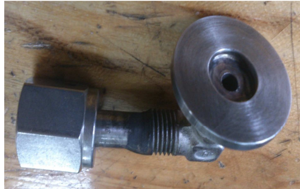
Figura B.23. Acople de tuberías
