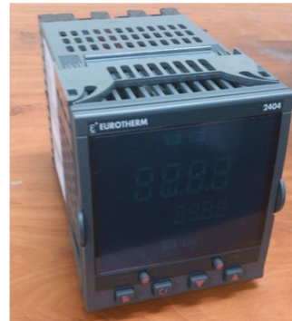
Figura 2.10. Controlador - Indicador de temperatura marca EUROTHERM. [Fuente propia].
