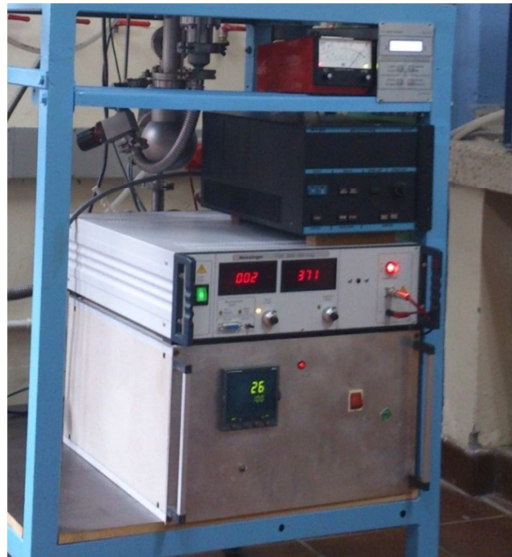
Figura 4.7. Panel frontal actual de trabajo del equipo Sputtering de tres (3) blancos [Fuente propia].
