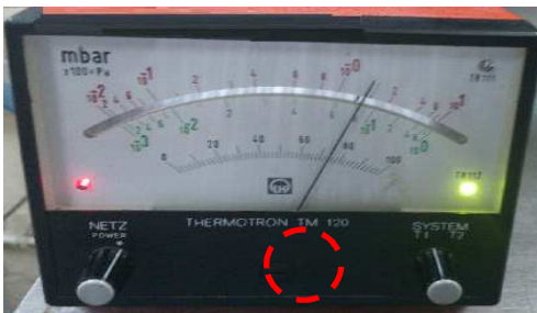
Figura 4.9. Resultado en rojo potenciómetro de calibración del indicador analógico de presión Thermotron TM 120 [Fuente propia].
