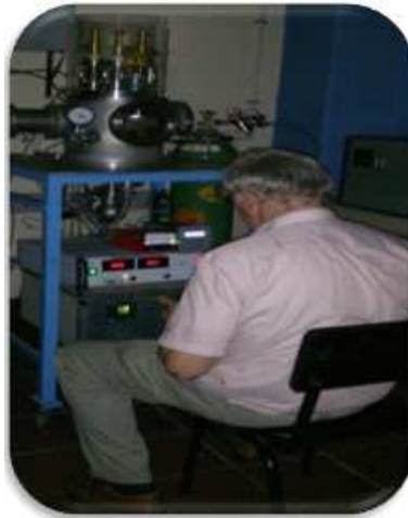
Figura 4.8. Sistema Sputtering ensamblado y funcionando con ayuda del Profesor Wilhem Evers del Centro de Investigación de Jülich-Alemania. [Fuente propia].
