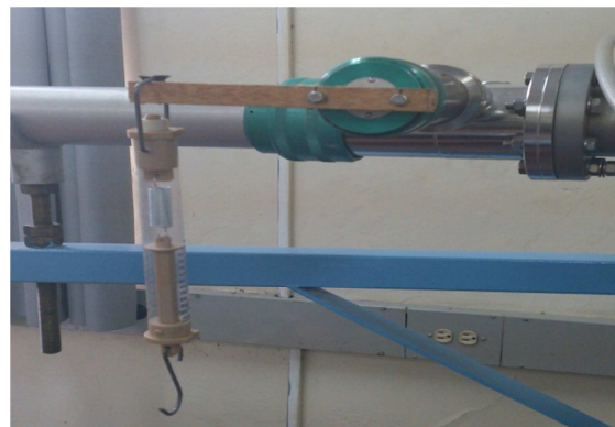
Figura 4.16. Caracterización torque perilla horno con el dinamómetro 2. [Fuente propia].
