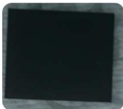
Figura 4.19. Crecimiento # 1 Película delgada obtenida de YBa2Cu3O 7 [Fuente propia].
