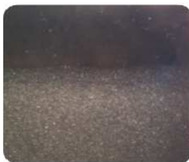
Figura 4.20. Crecimiento # 2 Película delgada obtenida de YBa2Cu3O 7 /Al 2 O 3
