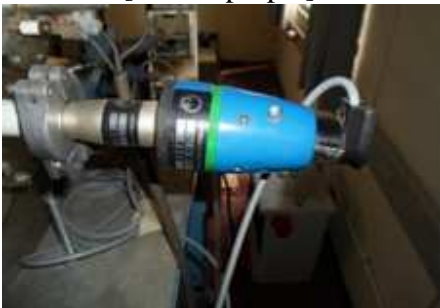
Figura 2.7. Sensor de Presión PIRANI – LEYBOLD HERAEUS. [Fuente propia].
