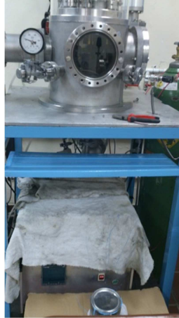
Figura 4.6. Evidencia de los trabajos realizados: Ensamblar y pintar el equipo Sputtering de tres (3) blancos. [Fuente propia].
