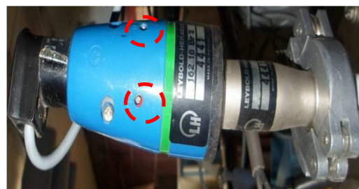
Figura 4.10. Resultados en rojo potenciómetros de calibración del sensor pirani [Fuente propia].
