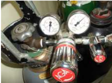
Figura 2.23. Válvula AGA y válvula AGA 2 de la bala de Nitrógeno. [Fuente propia].
