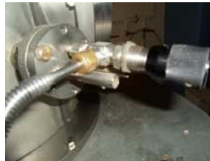
Figura 2.20. Válvula de flujo de entrada de Oxígeno a la cámara. [Fuente propia].
