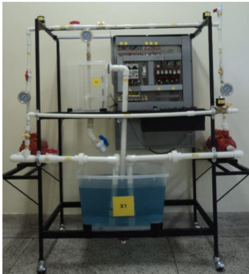
Figura 7 Banco de Pruebas Para Bombas Centrífugas.
