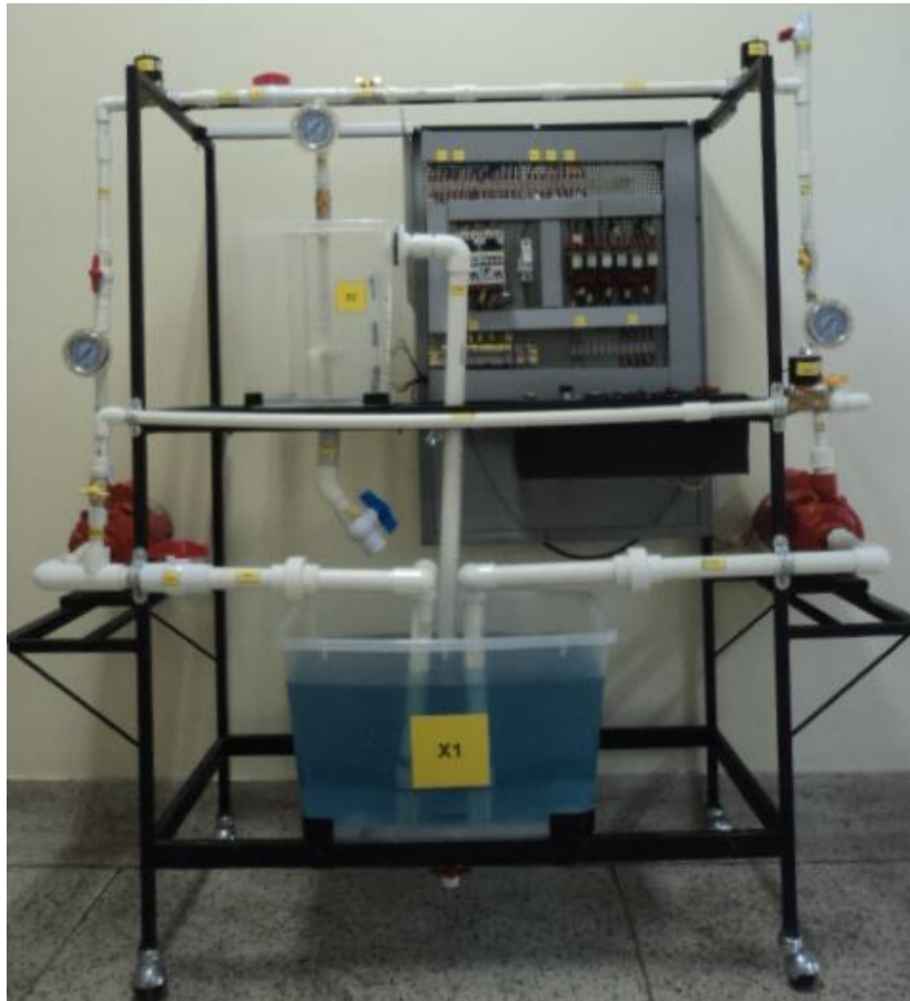
Figura 0.7 Banco de Pruebas para Bombas Centrífugas.
