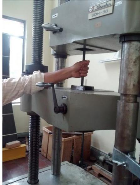
b) Montaje de varilla de acero sobre los cabezales del módulo de carga
