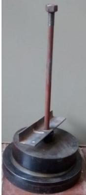
No.1: Elemento necesario para realizar el Ensayo de compresión, se debe ubicar en el cabezal inferior del marco de carga, ajustándolo en las mordazas de tal forma que tenga firmeza.
