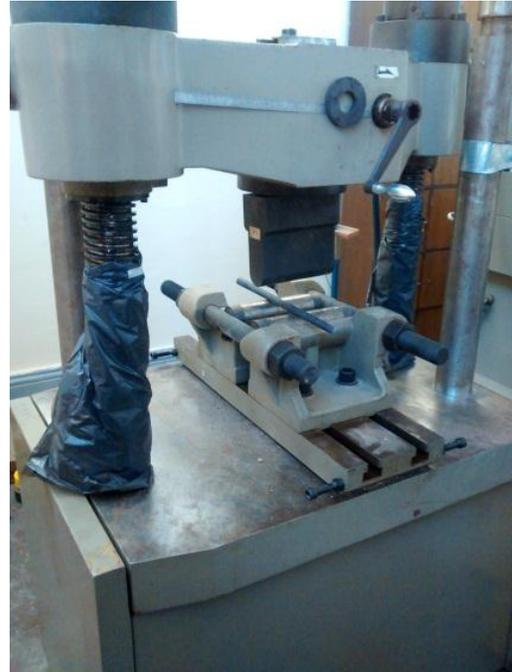
b) Montaje final de ensayo de flexión
