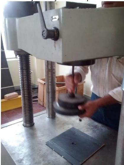
a) Ubicación de aditamento N.1 para ensayo de compresion en el cabezal inferior del modulo de carga
