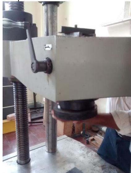
b) Ajuste de aditamento N.1 en el cabezal inferior del modulo de carga.
