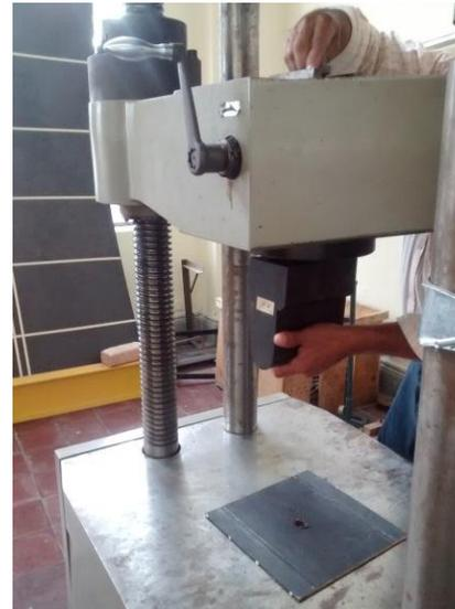
b) Aditamento N.2 ubicado en el cabezal inferior
