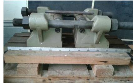
No.3: Elemento de soporte necesario para realizar el ensayo de flexión, se debe ubicar sobre la mesa de carga, sobre él se dispone la pieza a ser puesta a prueba.
