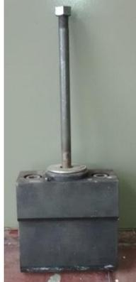
No.2: Elemento necesario para realizar el ensayo de flexión, este es ubicado en el cabezal inferior del marco de carga, ajustándolo en las mordazas de tal forma que tenga firmeza.
