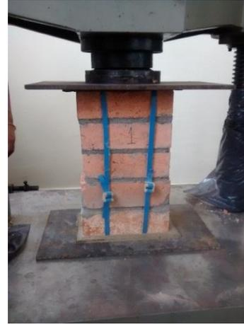
b) Aplicando carga en prisma rectangular por medio de aditamento N.1
