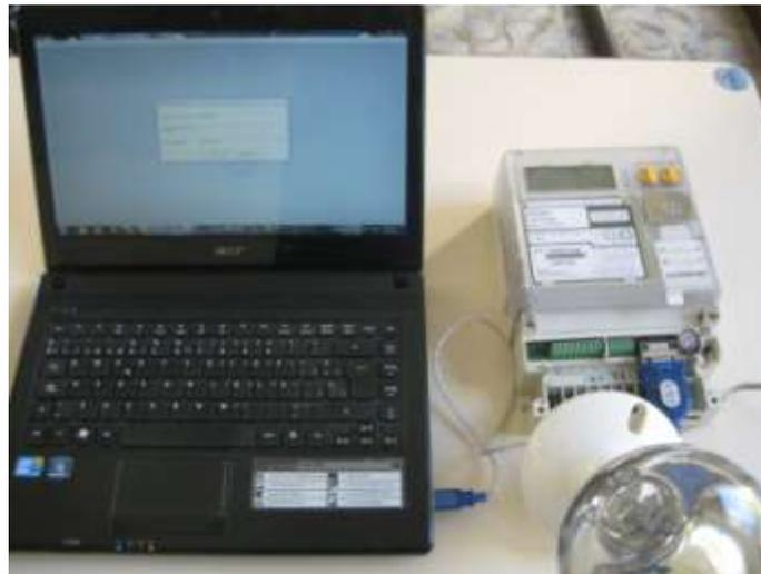
Figura 29 PC con Metercat conectado por medio de un cable serial a un Medidor Elster A1800
