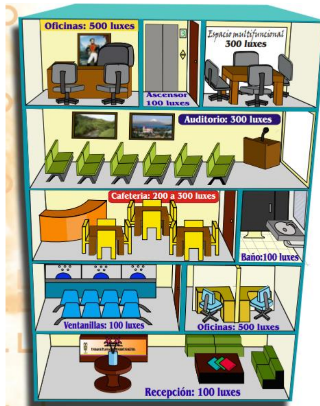
Figura 11. Nivel de iluminación en oficinas. Fuente [36]
