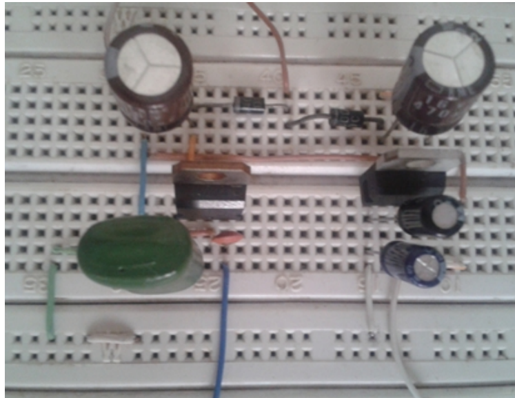
Figura 48. Implementación de fuente dual (-9, 9) V.
