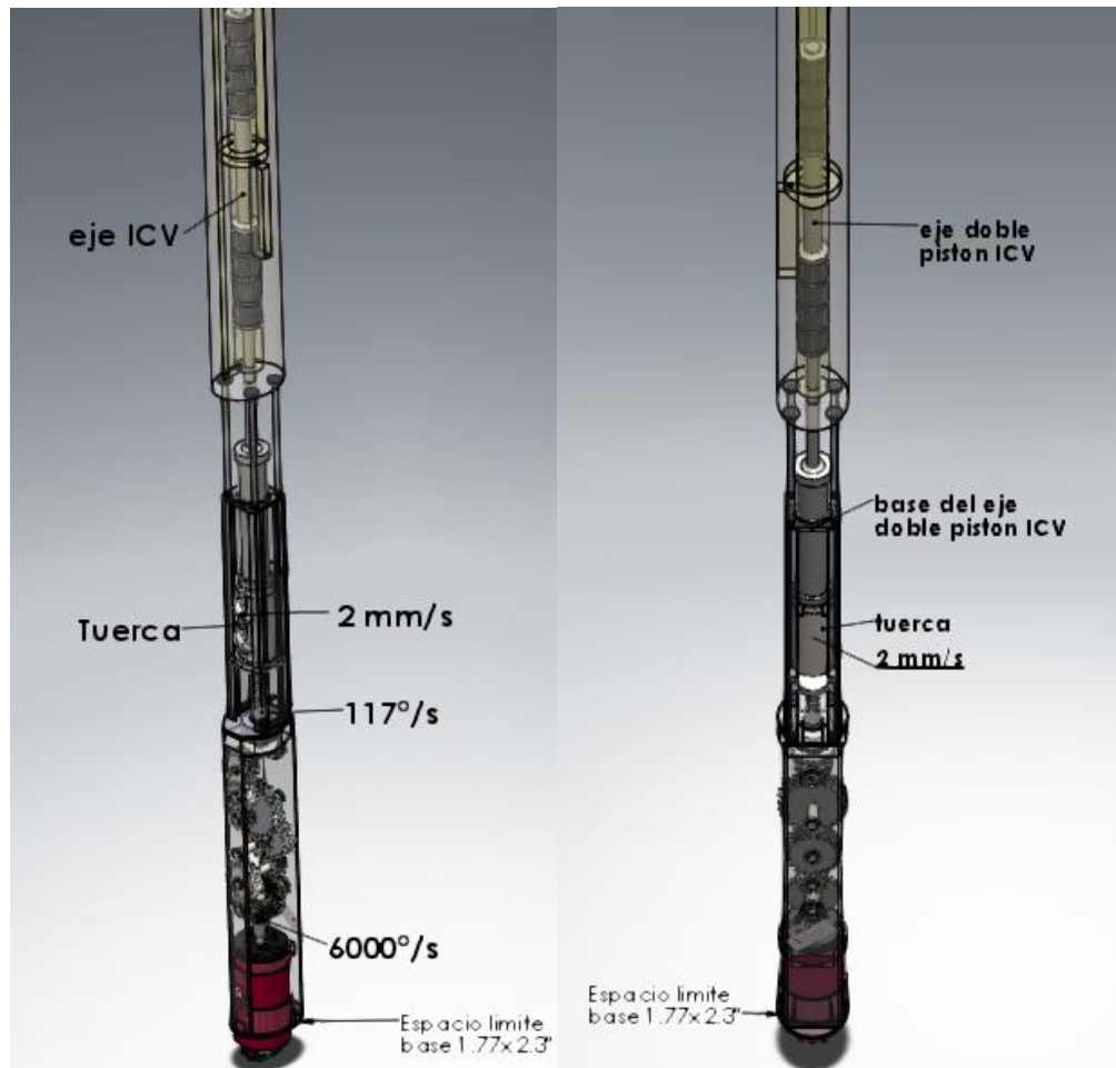
Figura 5.26. Cuerpo ICV acoplado al motorreductor con sus ocho relaciones. El motorreductor tiene como funciones entregar la potencia necesaria para mover el eje de la ICV y producir un movimiento lento para facilitar el control de posición del eje de la ICV para regular el caudal de inyección de agua. Fuente propia.
