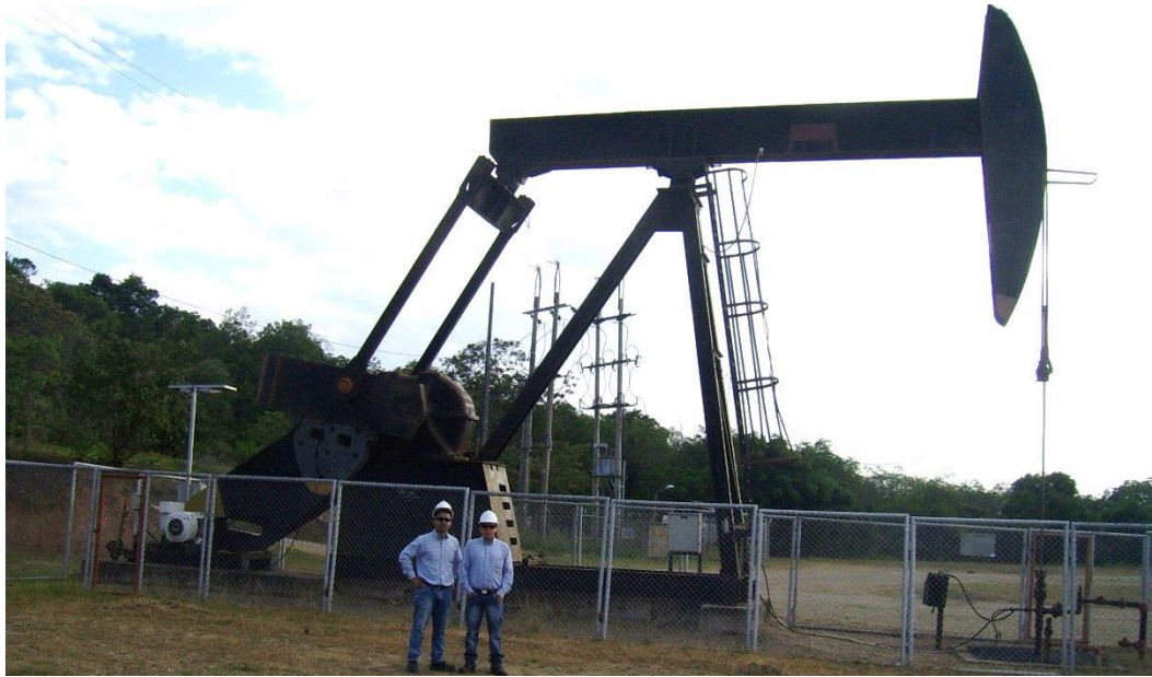
Figura 1.6. Método de producción primaria en Campo San Francisco Neiva - Huila: machín o unidad de bombeo mecánico. Fuente propia.
