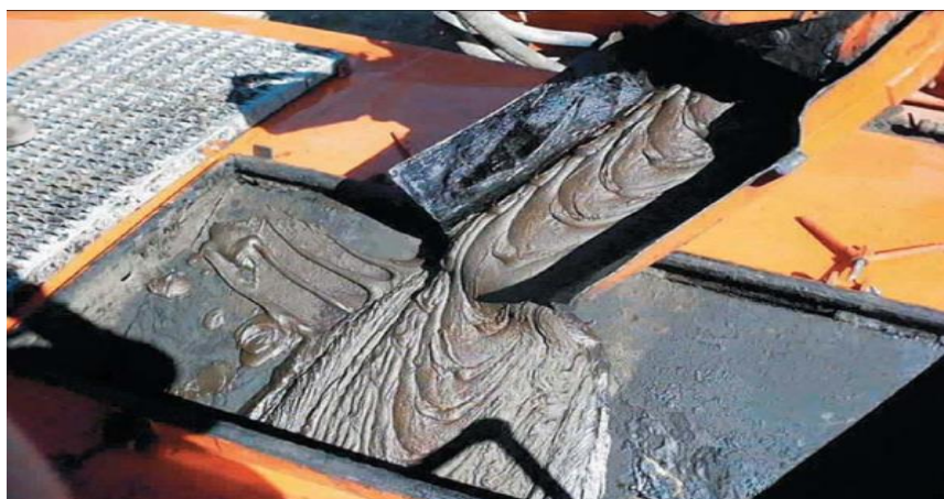
Figura 1.3. Producción de petróleo pesado en frío, con una composición del fluido de 15% de arcilla y sílice, 25% de petróleo viscoso, 60 % de agua. Tomado de [2].
