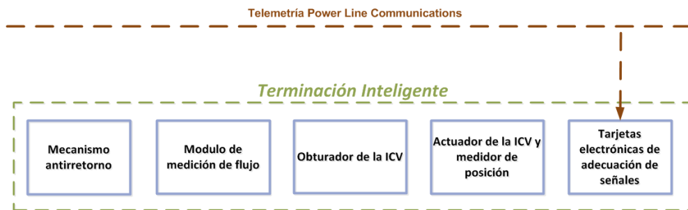
Figura 3.9. Diagrama de los componentes de una terminación inteligente propuesta. Fuente propia.
