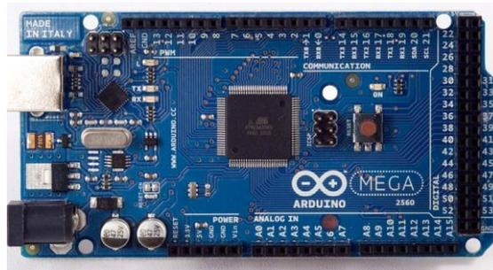
Figura 3. 18 Arduino Mega. Fuente [23].
