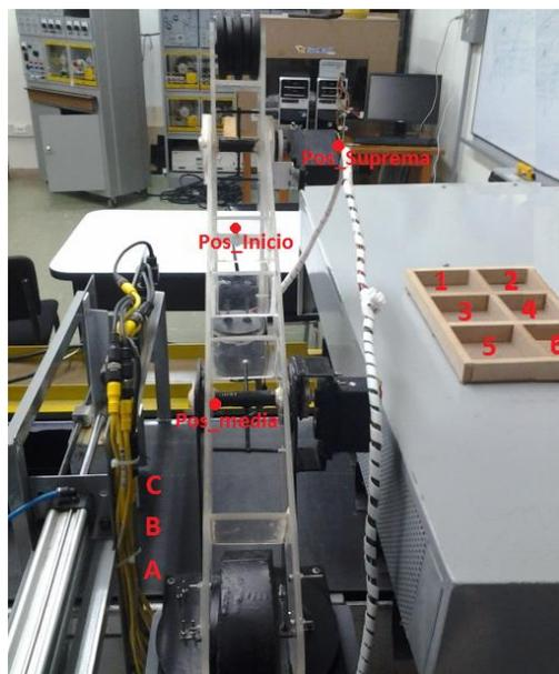
Figura 2. 14 Puntos de referencia para las trayectorias propuestas. Fuente elaboración propia.
