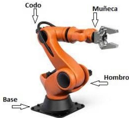
Figura 1. 1 Estructura física de un robot. Fuente [4]
