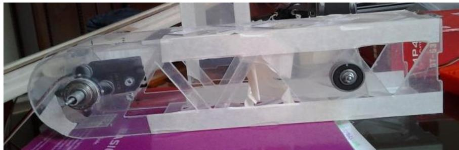
Figura 3. 8 Lateral derecho de la articulación tres. Fuente elaboración propia
