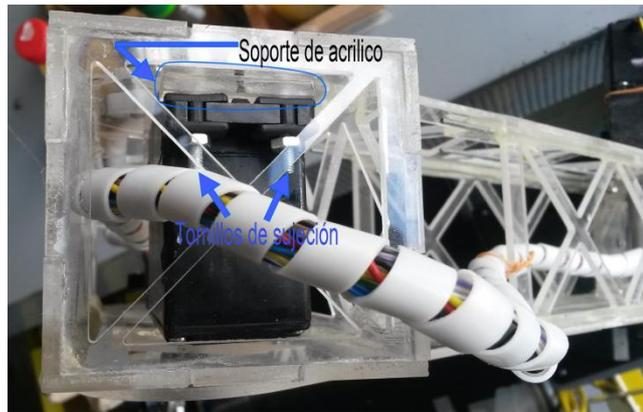
Figura 3.9 Soporte para el servomotor para la tercera articulación. Fuente elaboración propia.
