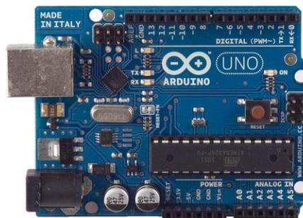
Figura 3. 19 Arduino Uno. Fuente [23].
