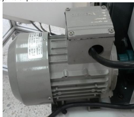
Figura 25. Motor trifásico marca SIEMENS adjunto al peletizador.
