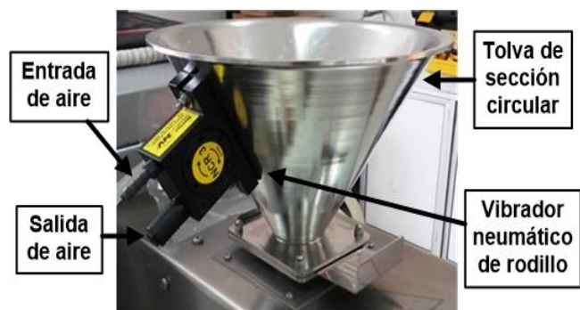
Figura 63. Tolva para alimentación y vibrador neumático de rodillo.
