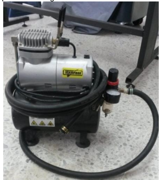
Figura 29. Compresor de aire marca Stanprof, usado para el soplado de la película biodegradable.
