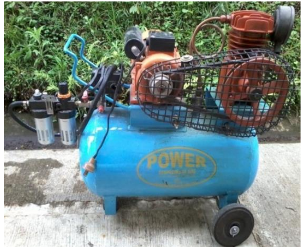
Figura 27. Compresor de aire marca POWER, usado para la refrigeración del extrusor de tornillo simple.
