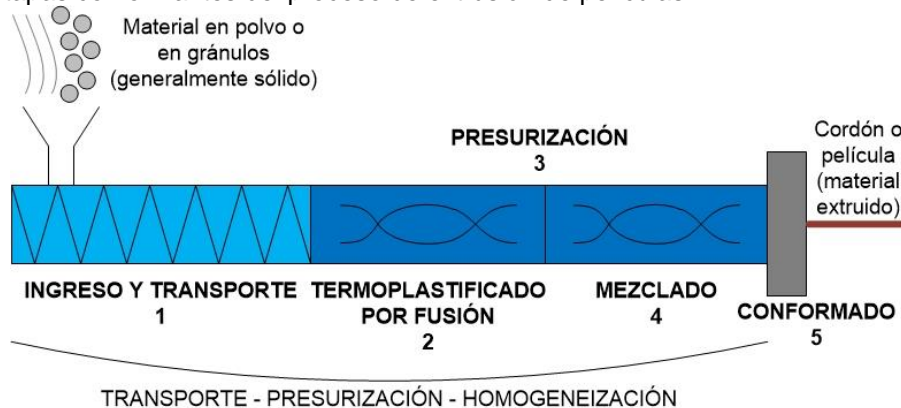
Figura 2. Etapas conformantes del proceso de extrusión de películas.
