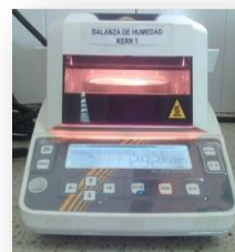
Figura 12 Verificado de humedad
