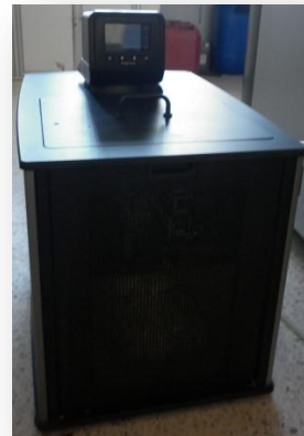
Figura 33 Refrigerador de circulación
