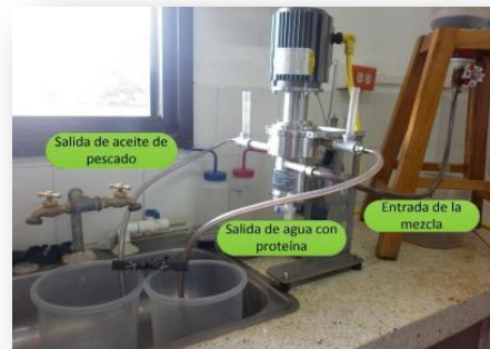
Figura 8 Separación de aceite y proteína con agua
