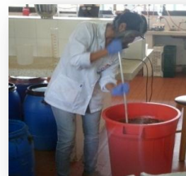
Figura 6 Mezclado de víscera y ácido
