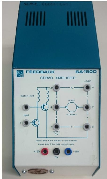
Figura 2.7: Servo Amplificador SA150D
