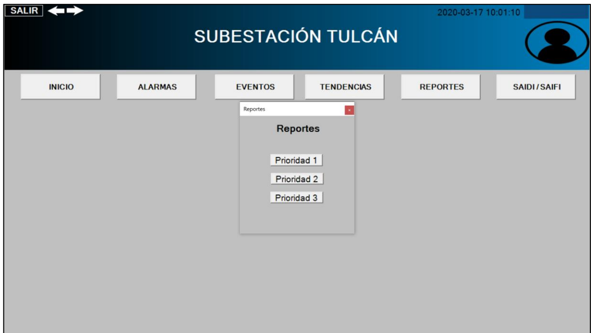
Figura 35. Ventana de Reportes interfaz SCADA. Fuente: Propia
