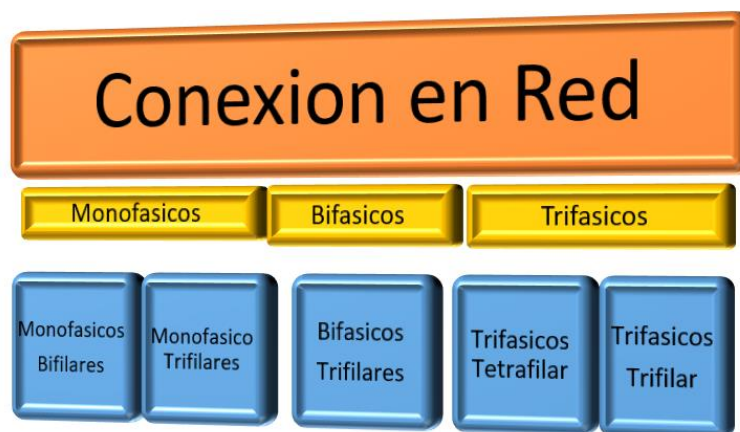
Figura 24 Conexión en red. Fuente elaboración propia.
