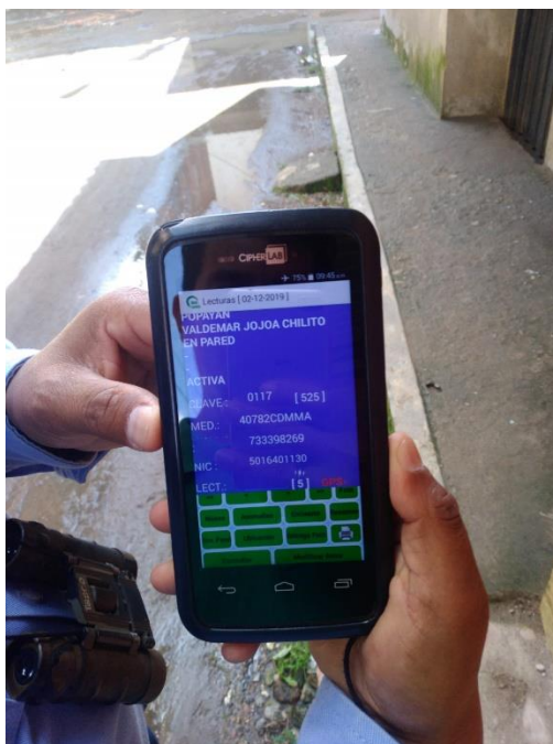
Ilustración B 8 Archivo fotográfico Aplicativo móvil usado para el registro de medidas operada por parte del personal encargado datos de usuario e ingreso de consumo eléctrico. Fuente elaboración propia.
