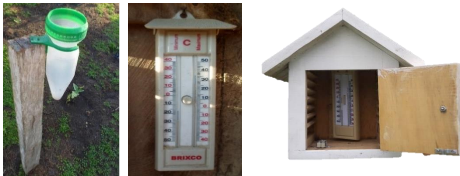
Fig. 3. Instrumentos que componen una estación climática comunitaria en el TeSAC Popayán: Pluviómetro (izq.), termómetro de máximas y mínimas (centro) y abrigo meteorológico (der.).
