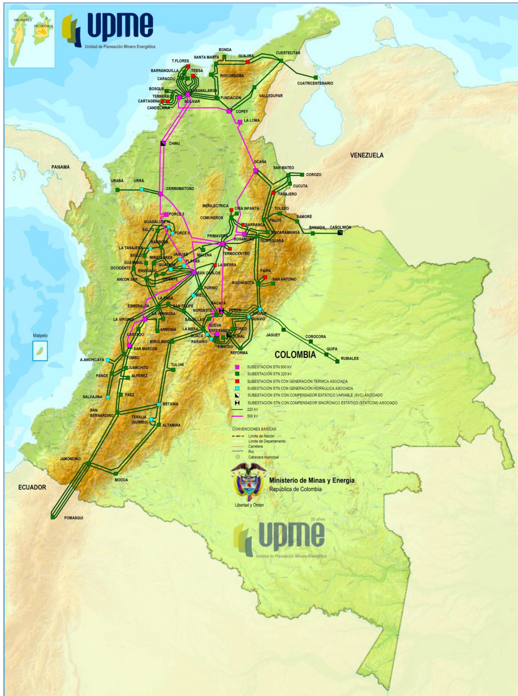
Figura 1: Sistema de transmisión nacional 2019. Fuente UPME.
