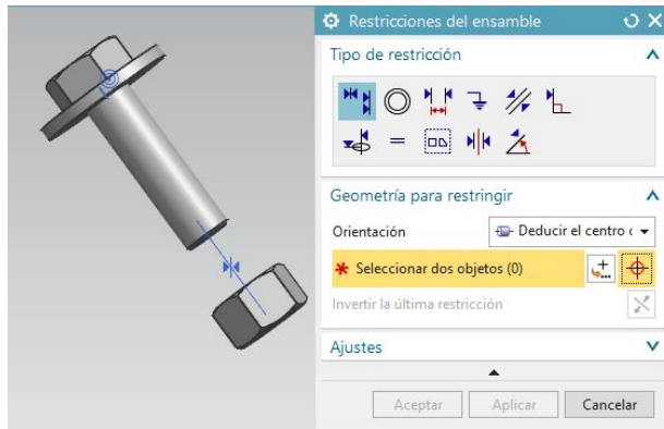
Figura A.23: Restricción deducir el centro o eje en NX.Tomada de NX Modelo-Ensamblaje
