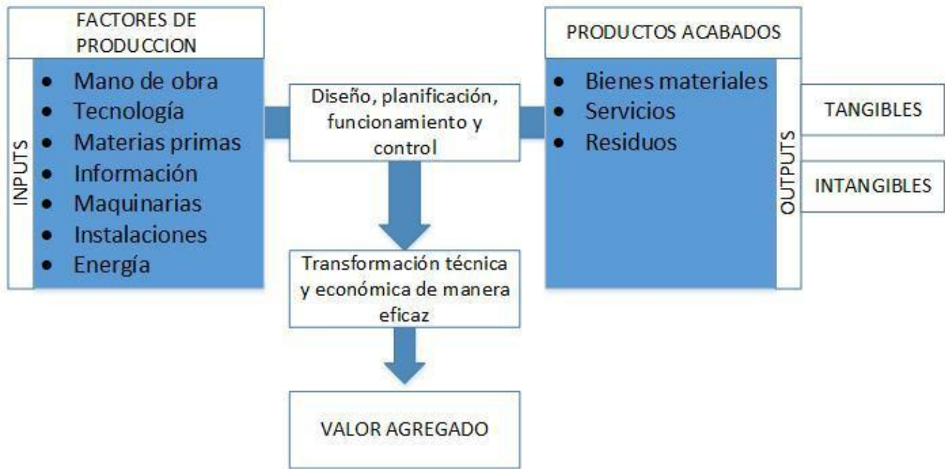
Figura 20: Esquema proceso de producción Fuente. Realización propia basada en, (Hernández et al) [62]
