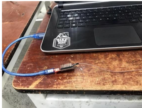
Figura. 5.2. Sistema electrónico para la realización de pruebas, adquisición y procesamiento de datos (modulo FTD1232). Fuente propia
