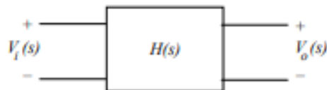
Figura.2.2 Red de dos puertos filtro activo-Fuente [10]
