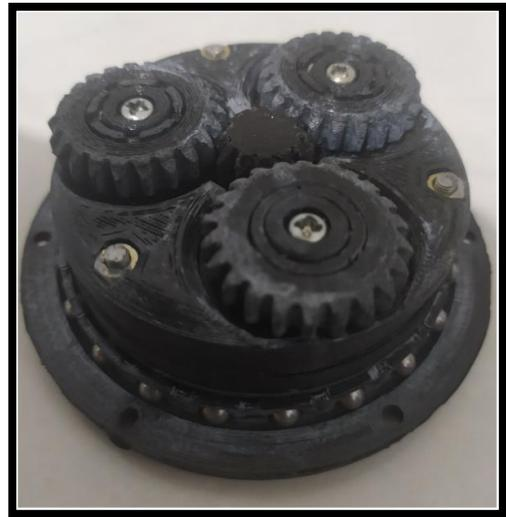
Figura 5.7. Rodamientos internos – caja de planetarios.
