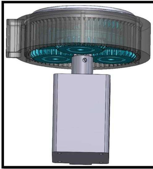
Figura 3.12. Sistema de accionamiento articulación tres.
