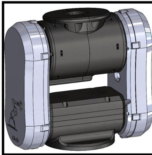
Figura 3.15. Sistema de accionamiento carcasa articulación cuatro.
