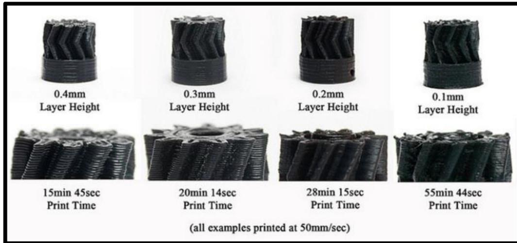
Figura 5.3. Altura de capa de la impresión 3D [51].
