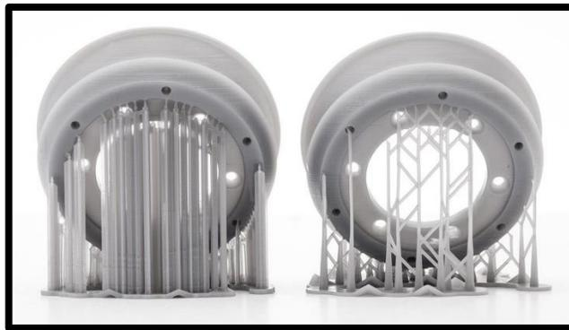
Figura 5.5. Soportes utilizados [52].
