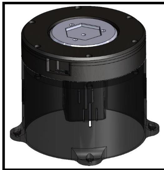
Figura 3.9. Sistema de accionamiento carcaza articulación uno.
