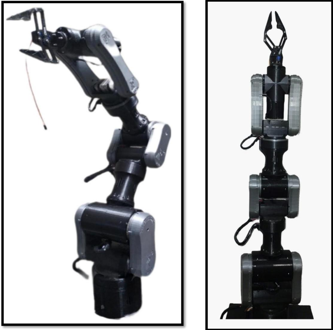
Figura 5.17. Prototipo de robot PA10 con pinza como órgano terminal (Vista lateral y frontal).
