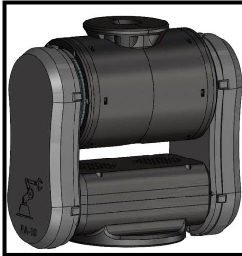
Figura 3.11. Sistema de accionamiento carcasa articulación dos.
