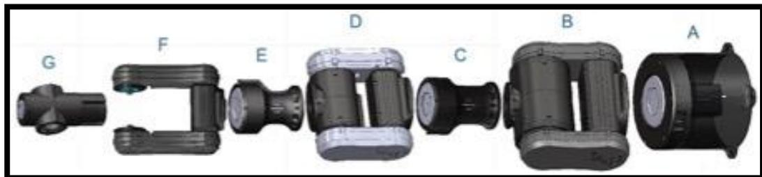
Figura 3.7. Prototipo de robot PA10 desensamblado por articulaciones.
