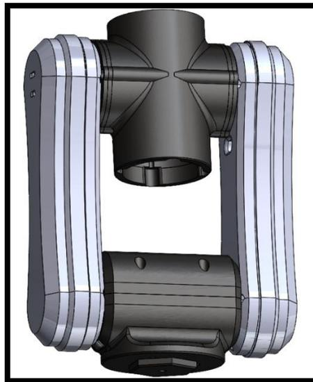
Figura 3.19. Sistema de accionamiento carcasa articulación seis.
