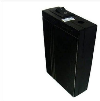
Batería recargable de 5V de Li-Ion de 4800mAh. La batería mide unos 57x95x20mm y pesa unos 195gr. Dispone de interruptor de encendido/apagado para saber cuando esta en marcha. Conector de carga standard de 2.1mm, salida con conector USB.
