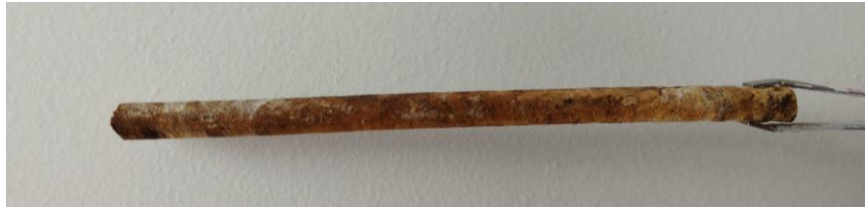
Figura 15: Cilindro obtenido con el barreno, fuente autor.
