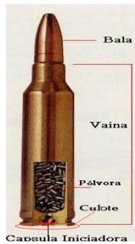
**Figura 2. Partes de un Cartucho (Tomado de [6])**
