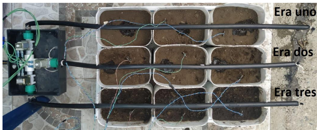
Figura 4.2 Montaje del sistema de riego
