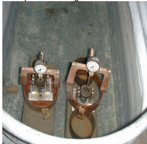
Figura 20. Fotografía del montaje para susceptibilidad al agua.
