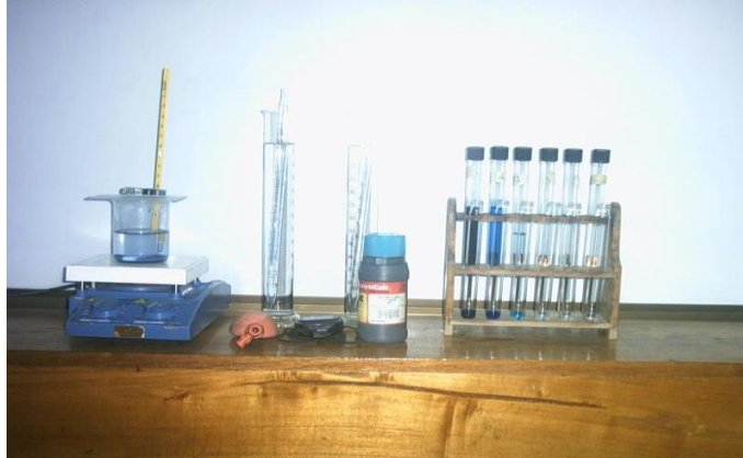
Figura 17. Fotografía del equipo de azul de metileno.
