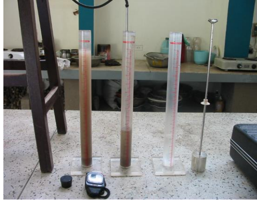
Figura 13. Fotografía del equipo de equivalente de arena.
