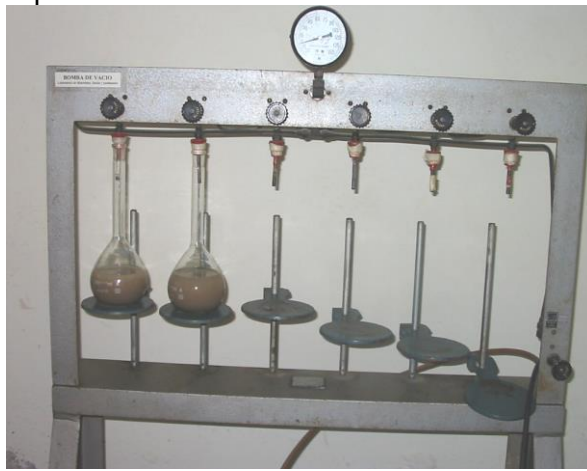
Figura 15. Fotografía del equipo de gravedad específica.
