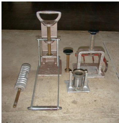
Figura 19. Fotografía del equipo Harvard Miniatura.
