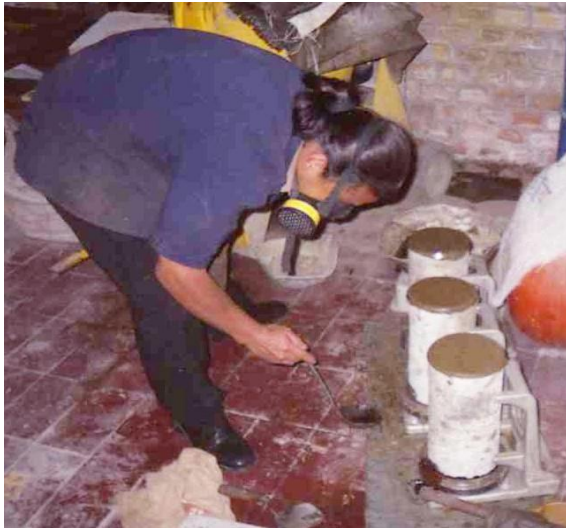
Refrentado de cilindros
