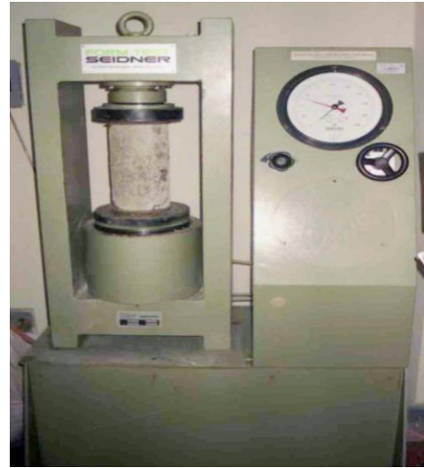
Rotura de cilindros
