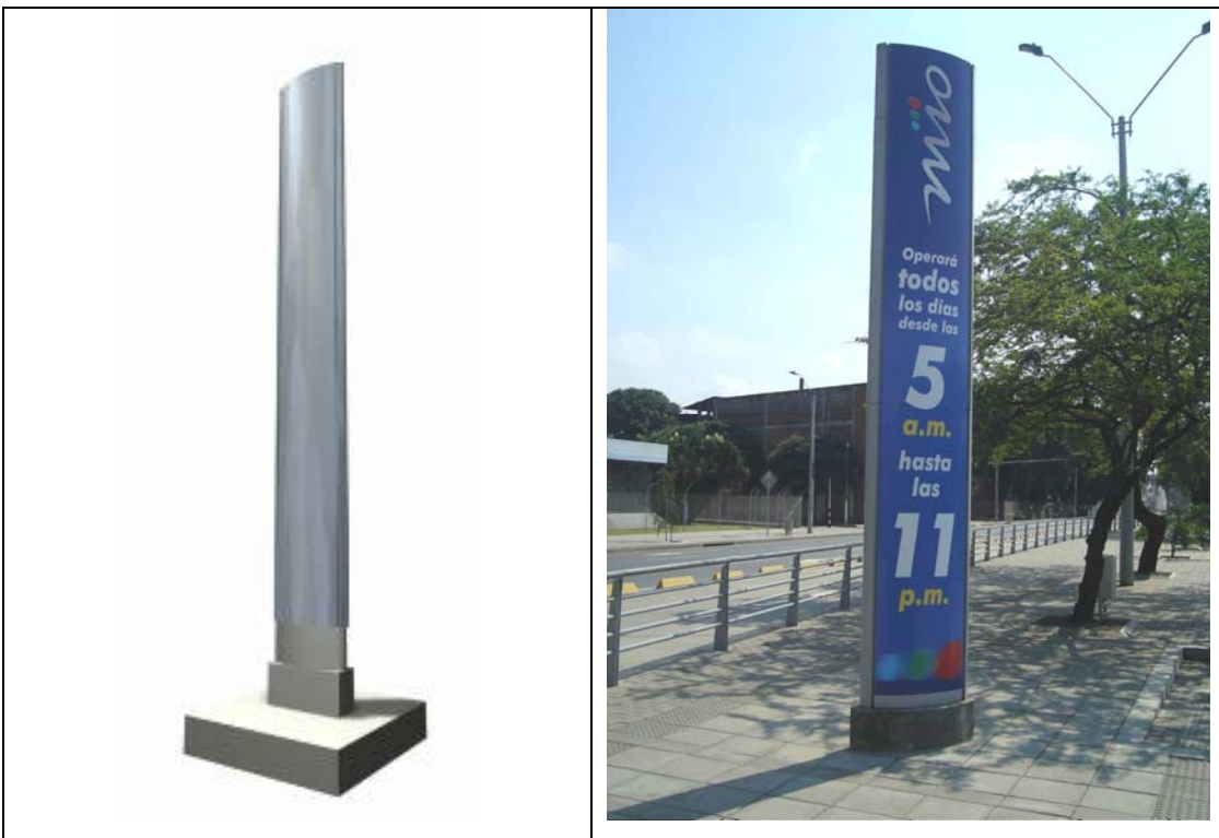
Panel empleado como elemento informativo y de señalización. Tiene dos caras con posibilidad de iluminación interna para albergar información comercial y planos de la Ciudad que permitan orientar al peatón.
