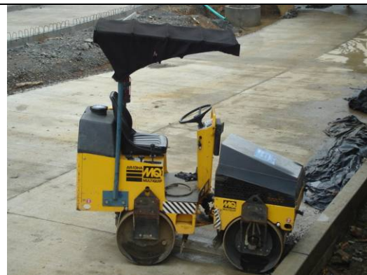
Compactador de rodillo de 4.0Ton
