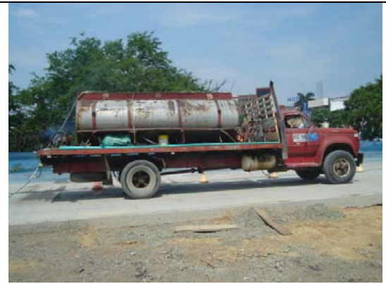
Carro tanque abastecedor de agua
