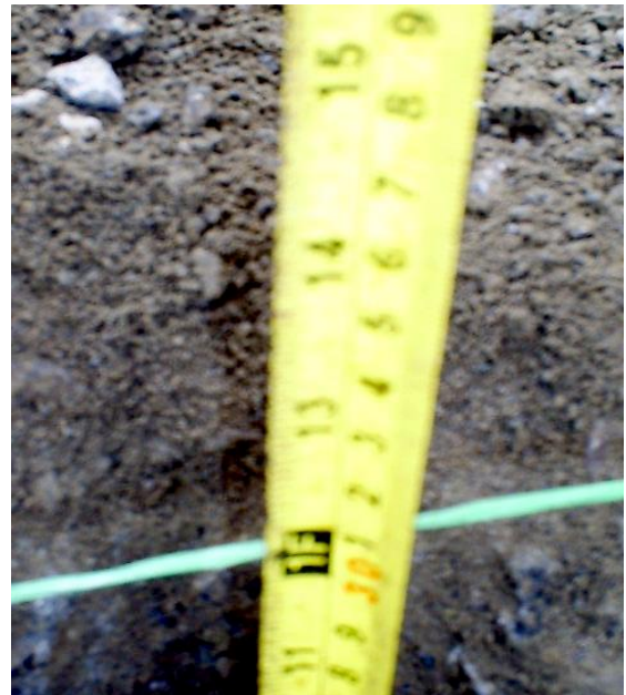
El espesor en el primer punto de perforación fue de 30 cm
