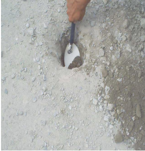
Se sigue perforando hasta alcanzar el nivel de rasante y se mide el espesor.
