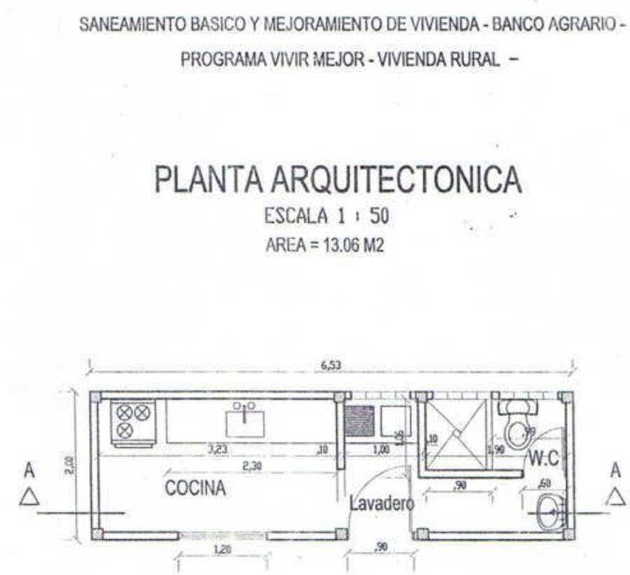
Figura 1. Planta Arquitectónica del proyecto
