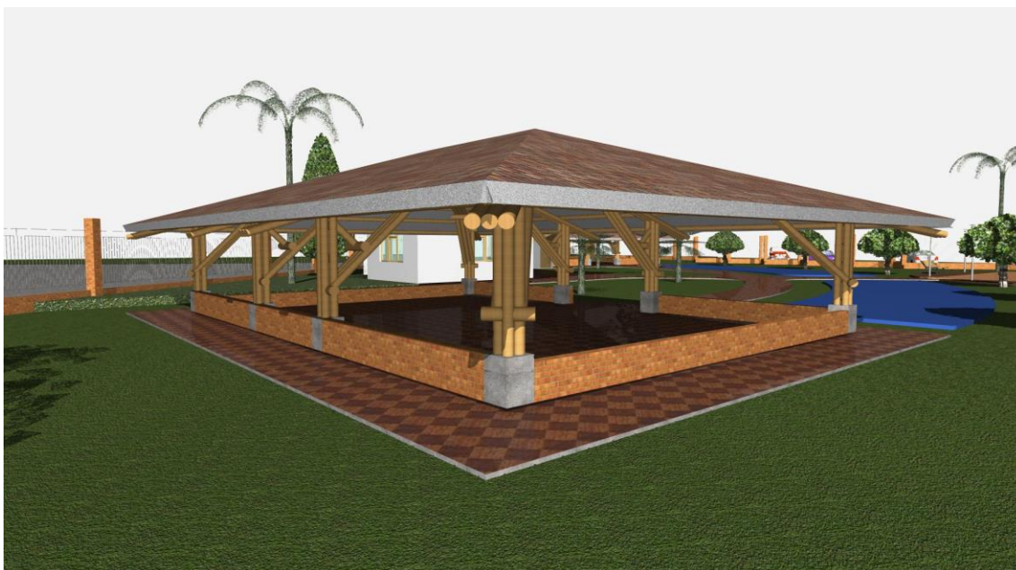
Figura 4. Proyección salón del sol (estructura en guadua y roble)
