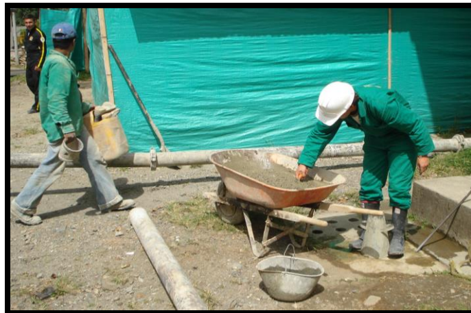
FOTO 28. ELABORACION DEL CONO PARA ENSAYO DE ASENTAMIENTO
