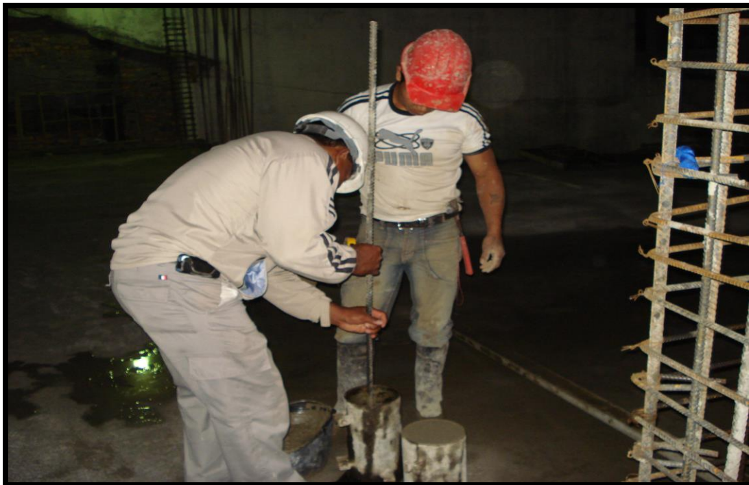
FOTO 58. ERRORES EN LA TOMA DE CILINDROS
