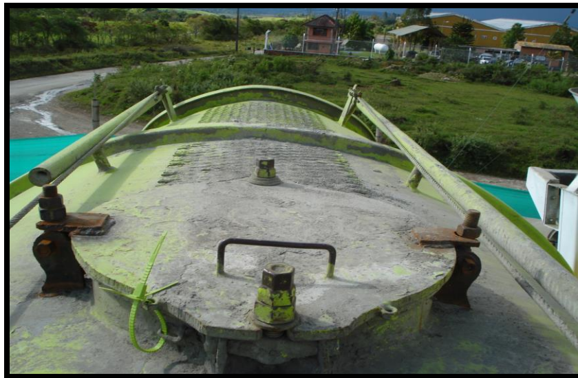
FOTO 10. SISTEMA DE SEGURIDAD DEL CAMION DE ARGOS
