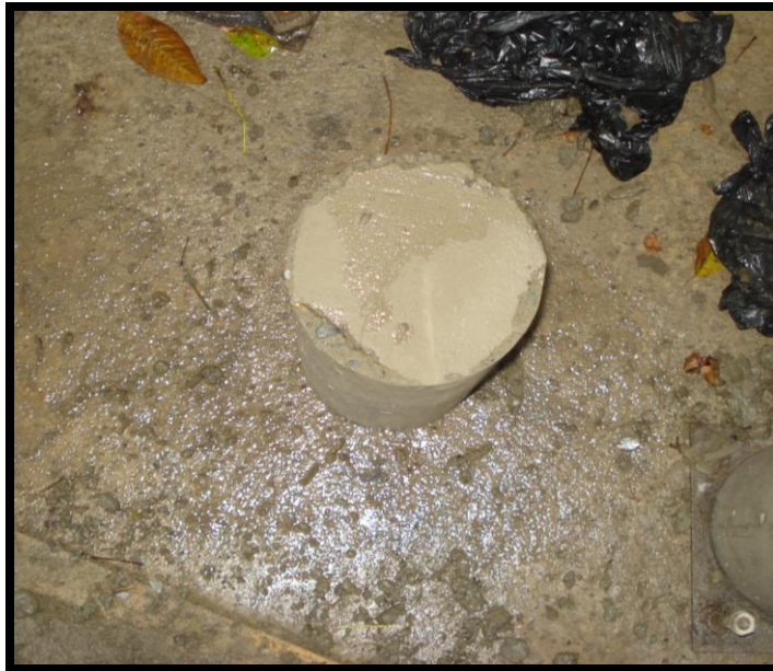
FOTO 59. CILINDRO ASTILLADO LUEGO DE DESENCOFRAR
