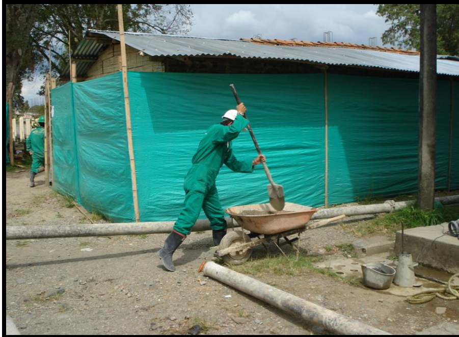
FOTO 26. MEZCLADO DE LA MUESTRA EN LA CARRETILLA CON PALA
