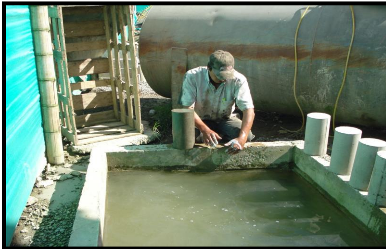
FOTO 23. OPERARIO VERIFICANDO CILINDROS ENUMERADOS
