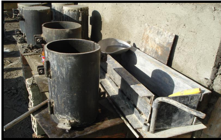
FOTO 22. MOLDES PARA ELABORAR CILINDROS Y VIGUETAS
