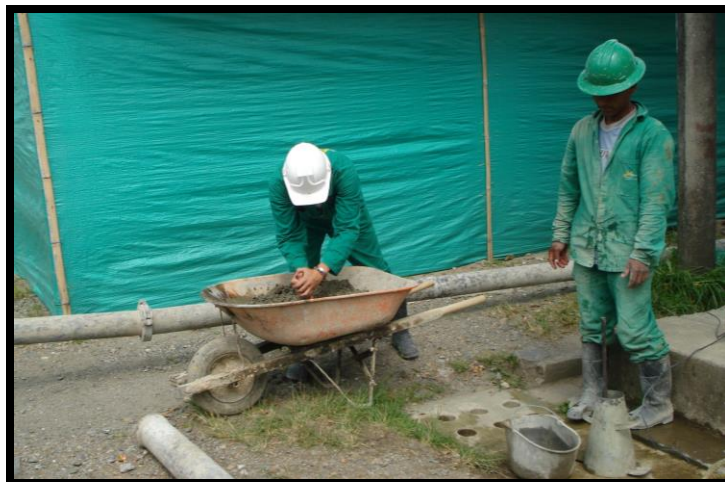
FOTO 27. MEZCLADO DE LA MUESTRA EN LA CARRETILLA CON ESPÁTULA
