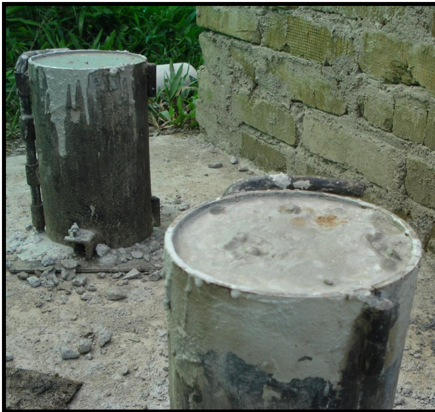
FOTO 61. CILINDROS MAL ELABORADOS
