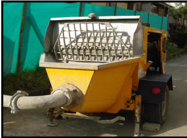
FOTO 38. DETALLE TOLVA BOMBA ESTACIONARIA
