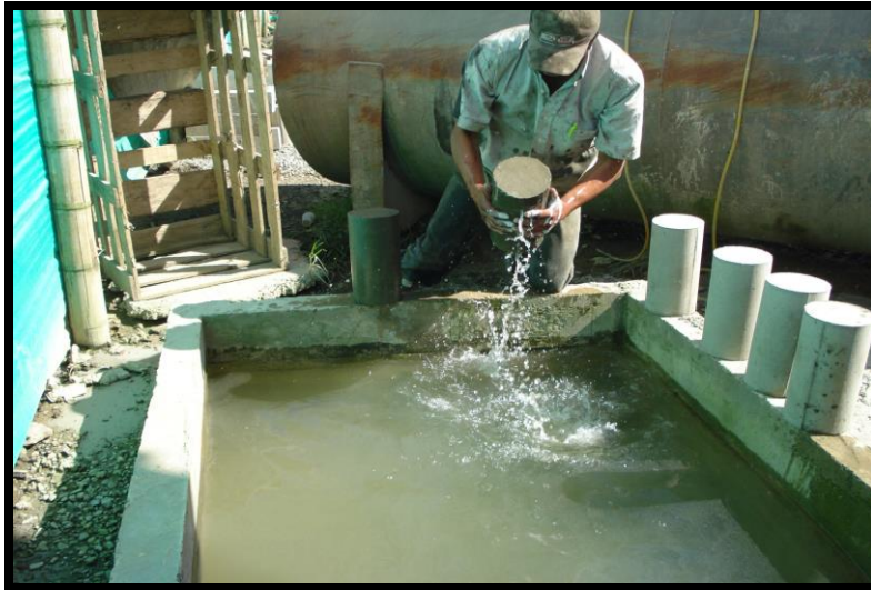
FOTO 24. OPERARIO SACANDO CILINDROS LISTOS PARA ENSAYOS
