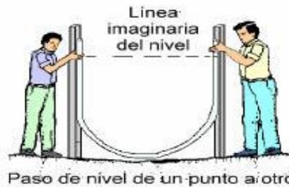
Figura 15. Transferencia de niveles por medio de manguera con agua.
