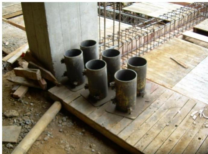
Figura 34. Cilindros para ensayos de concreto en elementos estructurales zona F.
