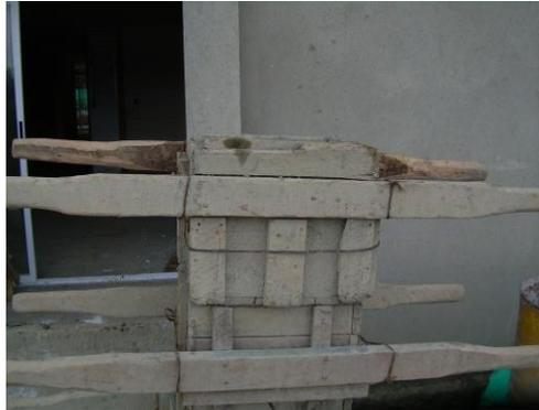
Figura 18. Recipientes de madera para dosificar la mezcla de concreto
