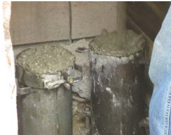
Figura 45.Toma de cilindros del concreto premezclado
