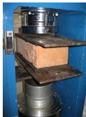
Figura 68. Ensayo de compresión de los ladrillos
