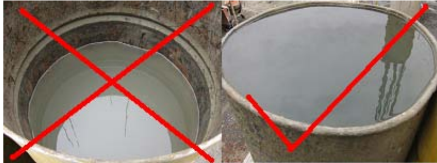
Figura 14. Agua adecuada que se debe utilizar en la obra
