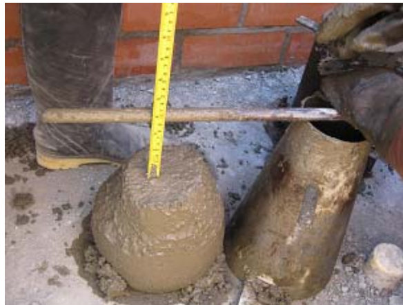
Figura 23. Asentamiento de mortero de relleno
