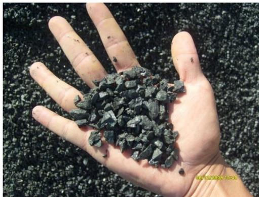
Fig.5.4 Triturado de 3/8" del Dpto. del Valle para grouting
