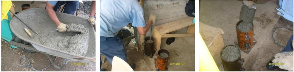
Fig.7.12. Ensayos de laboratorio para diseño de mezclas.
