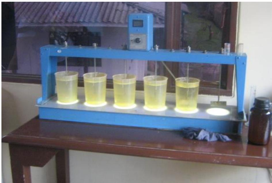
**Figura 13.** Equipo para prueba de jarras. Planta de Tulcán.
