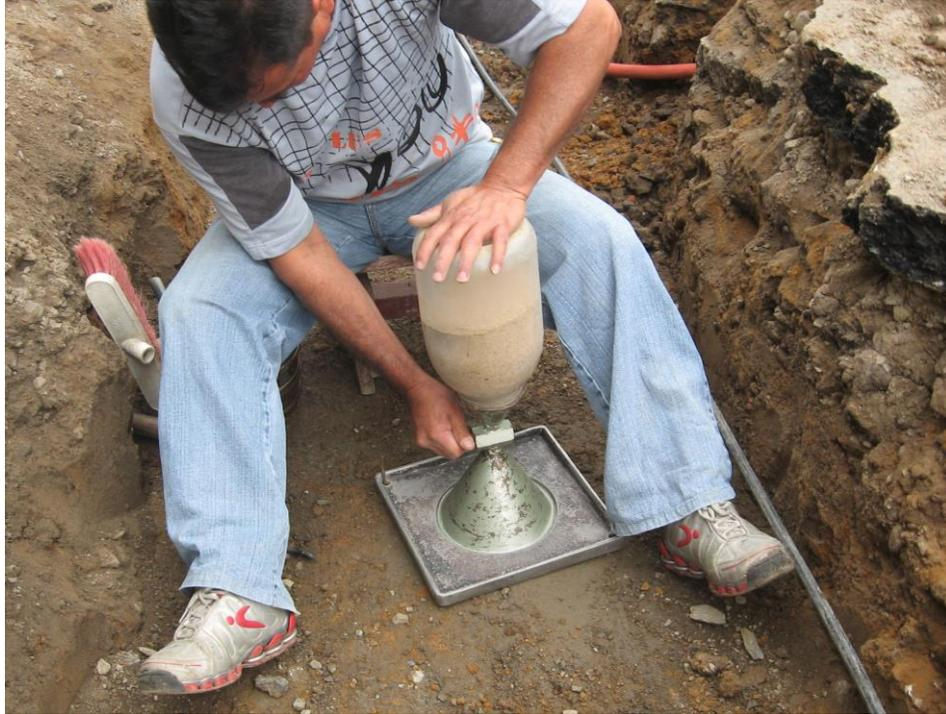
**Figura 31.** Toma de densidades en el campo con Cono de Arena para determinar el Grado de Compactación de los rellenos.
