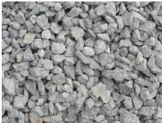
Figura 75. Triturado utilizado en obra
