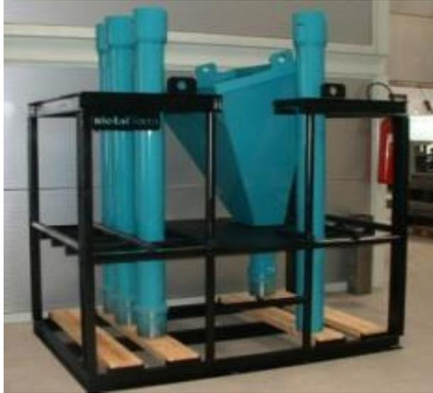
Figura 3. Detalle de la tubería tremie.
