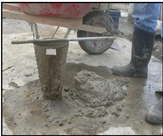
Foto 23. Slum tomado para columna primer piso
